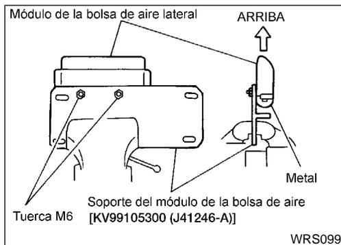
2. Asegure firmemente el soporte del módulo de la bolsa de aire [SST: KV99105300 (J-41246-A)] en un tornillo de banco.
