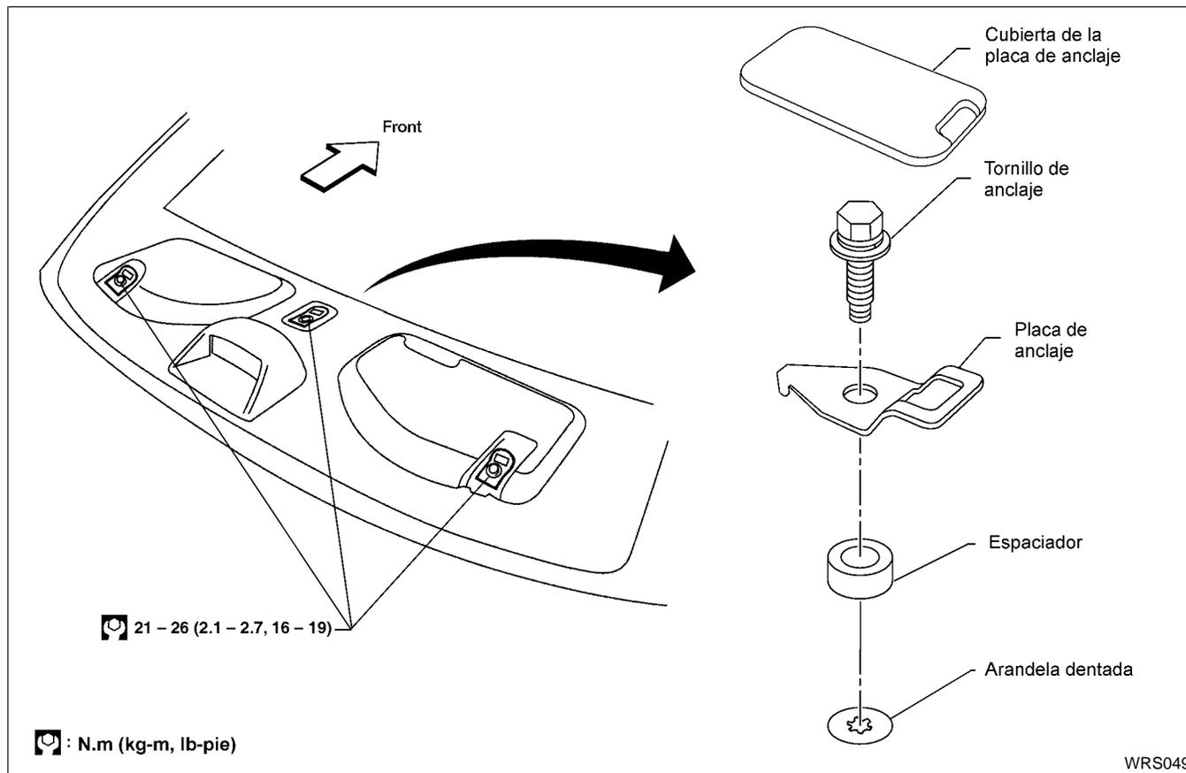
1. Quite la cubierta la placa de anclaje de la correa. Para más detalles, consulte CB-27, "ACABADOS LATERALES Y DEL PISO".
