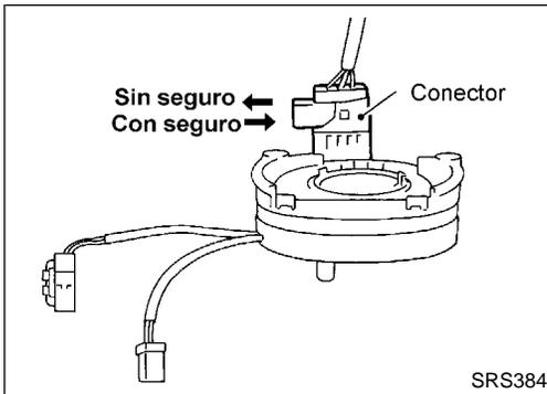
7. Desconecte el conector del cable en espiral. Después desconecte los conectores y remueva los cuatro tornillos. El cable en espiral ahora puede ser removido.
