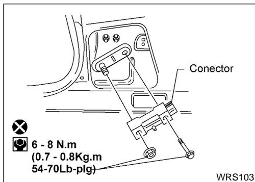
1. Quite el pretensor del cinturón de seguridad delantero. Consulte "Cinturón de Seguridad Delantero", RS-5 para más detalles.
