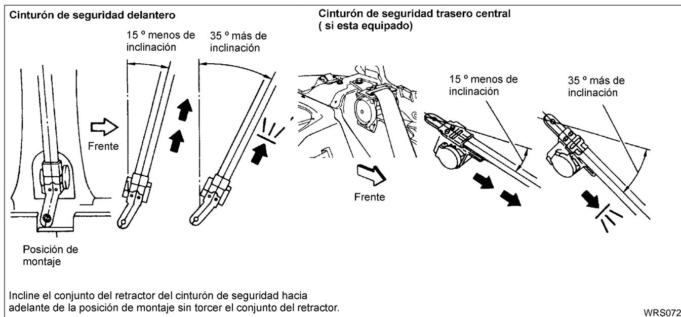
Si la prueba resulta negativa, reemplace el conjunto del retractor.
