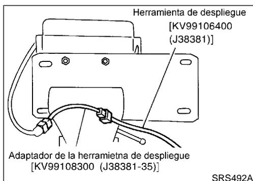
4. Conecte el adaptador de la herramienta de despliegue [SST: KV99108300 (J38381-35)] al conector de la herramienta de despliegue [SST: KV99106400 (J38381)] y al conector en el módulo de la bolsa de aire.
