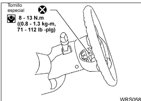
7. Coloque el módulo de la bolsa de aire del conductor, presione firmemente y apriete con tornillos especiales nuevos.
