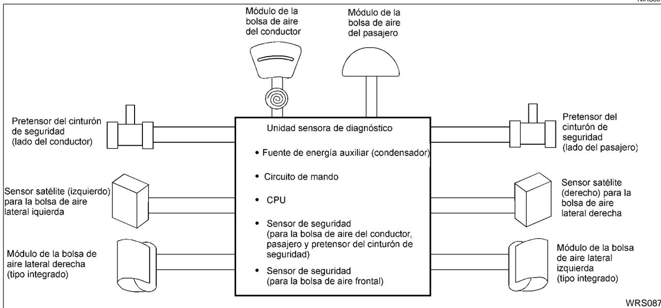
La bolsa de aire se despliega si la unidad sensora de diagnóstico se activa mientras el interruptor de encendido está en la posición "ON" o "START".
