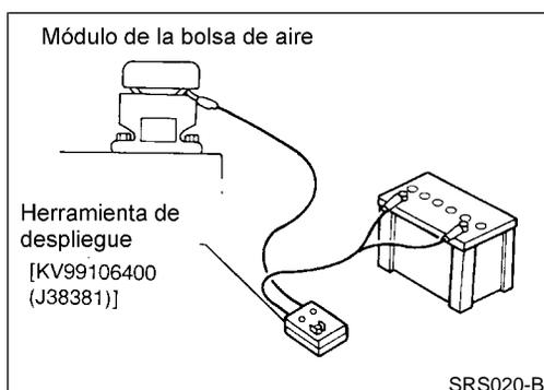
5. Conecte la pinza roja de la herramienta de despliegue a la terminal positiva y la pinza negra a la terminal negativa del acumulador.
