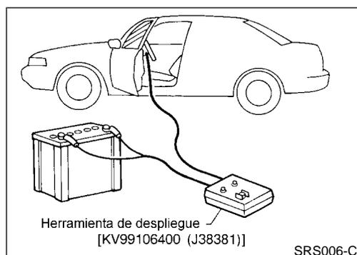
4. Conecte la pinza roja de la herramienta de despliegue a la terminal positiva y la pinza negra a la terminal negativa del acumulador.
